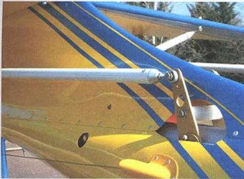
On note aussi que tous les renvois de la profondeur sont fait par rotules. Rigides, également, les commandes d'ailerons.
