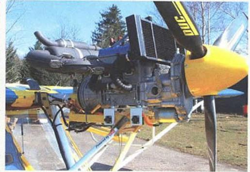
Par sa position au-dessus du cockpit, le moteur induit une visibilité vers l'avant passablement obstruée par les tubes et haubans du bâti moteur. En contrepartie, le capot très court autorise une vue en plongée assez satisfaisante.
